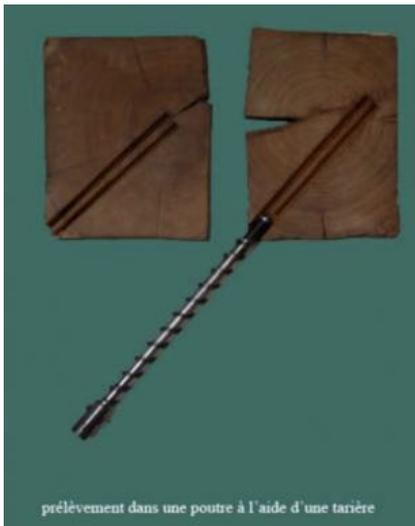
prélèvement dans une poutre à l'aide d'une tarière
